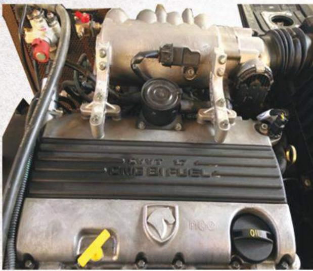
مجموعه دارای سیستم مدیریت سوخت ECU بوش نوع Bosch 7.4.9 طرح مشترک با سیستم گاز، و مجموعه انژکتورهای برقی و همچنین دارای نمایشگر گرافیکی مقدار گاز موجود در مخزن در آمپر، دارای سیستم ایموبلایزر با اجزاء ترنسپوندر، ICU و تراشه سوئیچ، دارای مدارات کاهش آلایندگی از جمله باک اصلی و مخزن انبساطی، کنیسترهای شیر برقی کنیستر دارای مدار شارژ و باتری اتمی 12V 65AH دارای کانکتور عیب یابی جهت تست مدار ایموبلایزر، سیستم گاز و تست سنسورها و عملگرها
