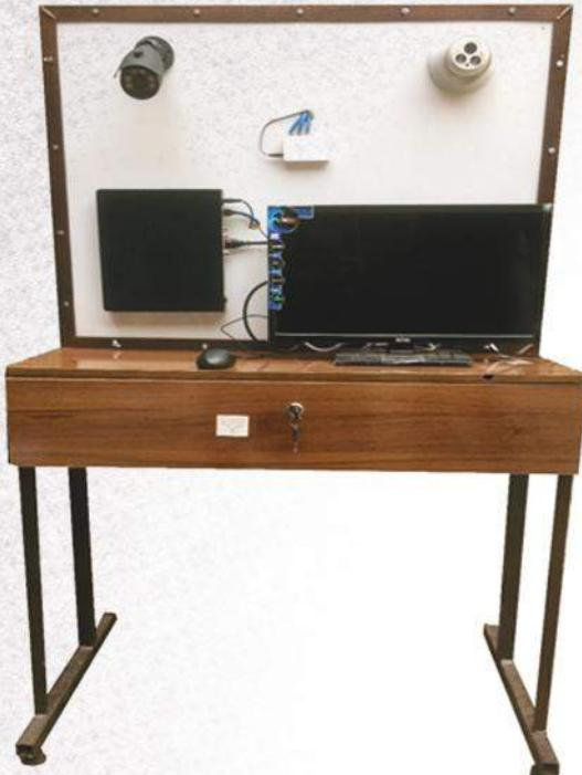
دارای شاسی فلزی با ورق پلی کربنات ورنگ کوره ای الکترو استاتیک چرخ دار و همچنین دارای دستگاه NVR چهار کanal دوربین دام و دوربین بولت IP تحت شبکه و مانیتور ۱۵ اینچ و سوئیچر ارتباطی قطعات با همدیگر، منبع تغذیه
