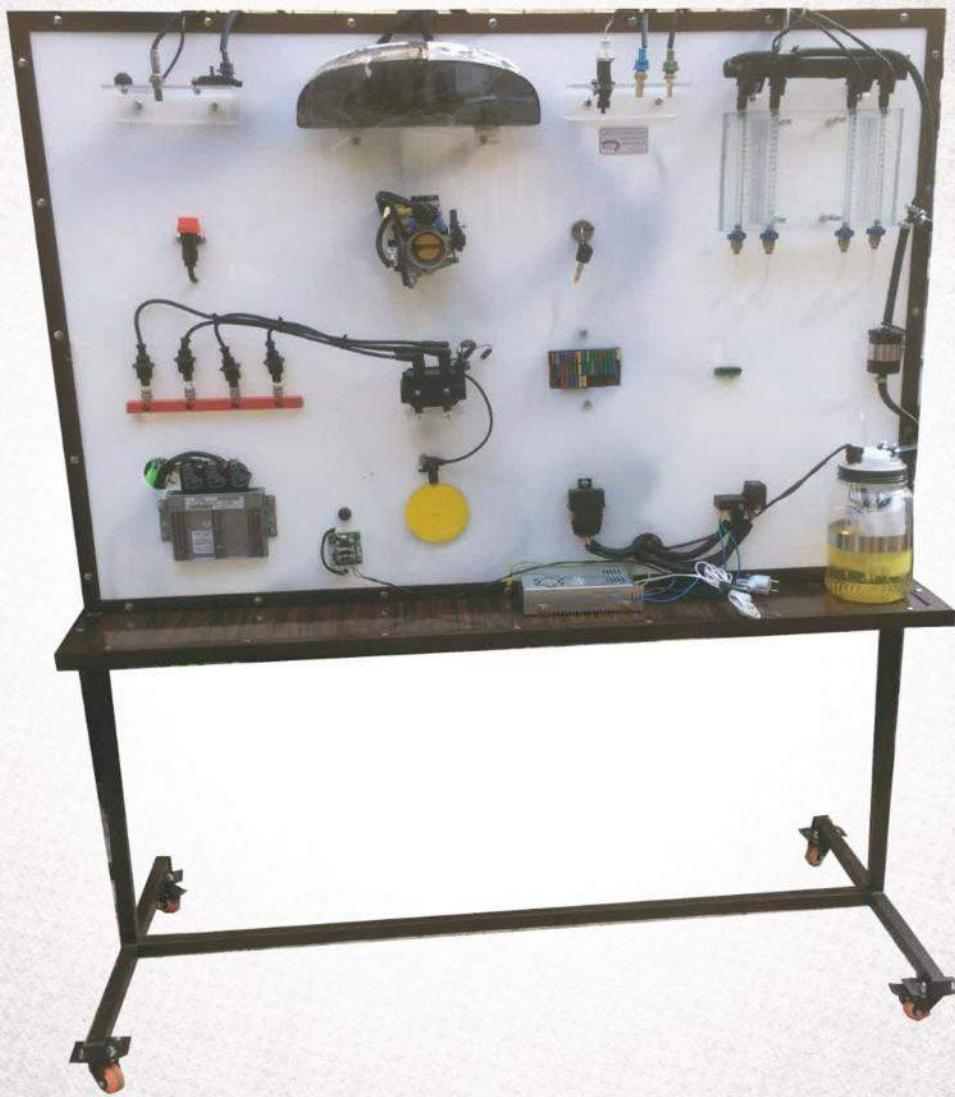
دارای شاسی فلزی با رویه پلی کربنات و دارای سیستم مدیریت سوخت رسانی SIEMENS به همراه پمپ بنزین In tank با رگلاتور تنظیم فشار سوخت سر خود، دارای فلاکویل شبیه سازی شده با اینورتر جهت تغییر دور فلاکویل، دارای پشت آمپر جهت نمایش پارامترهای دور موتور، کیلومتر، دمای آب و نمایش سطح سوخت، مدار هوای رسانی دارای دریچه هوای ورودی به همراه تمامی سنسورها و عملگرها، دارای سوئیچ استارت، دسته سیم های اصلی، جعبه تقسیم کالسکه ای و جعبه فیوز اصلی
