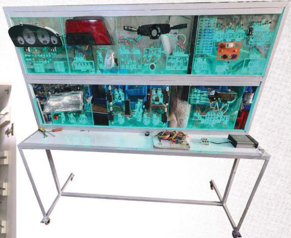
تابلو با فرم فلزی و چرخ گردان قفل دار از جنس پلکسی گلس با تجهیزات مدارات کامل روشنایی چراغ های جلو و عقب، منبع تغذیه داخلی ۱۲ ولت، دستک راهنمای و دستک برف پاکن، راهنمای و فلاشر، سوئیچ استارت برف پاکن، آپیاش و شیشه بالابرها بر قی معمولی و اتومات، کالسکه ای و جعبه فیوز اصلی، قفل مرکزی کامل پنل بخاری روتاری، مقاومت فن و صفحه رله ها، دارای کمد نگهداری تجهیزات، تمامی مدارات بر قی دارای چاپ و حک لیزری بوده و تک تک نقشه ها بر روی موزائیک های مذکور وجود دارد.
